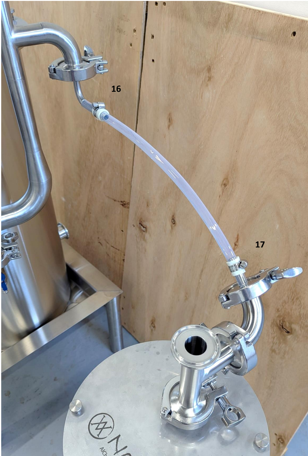
Photo 9 : Connexion du vase florentin sous vide au Nano
