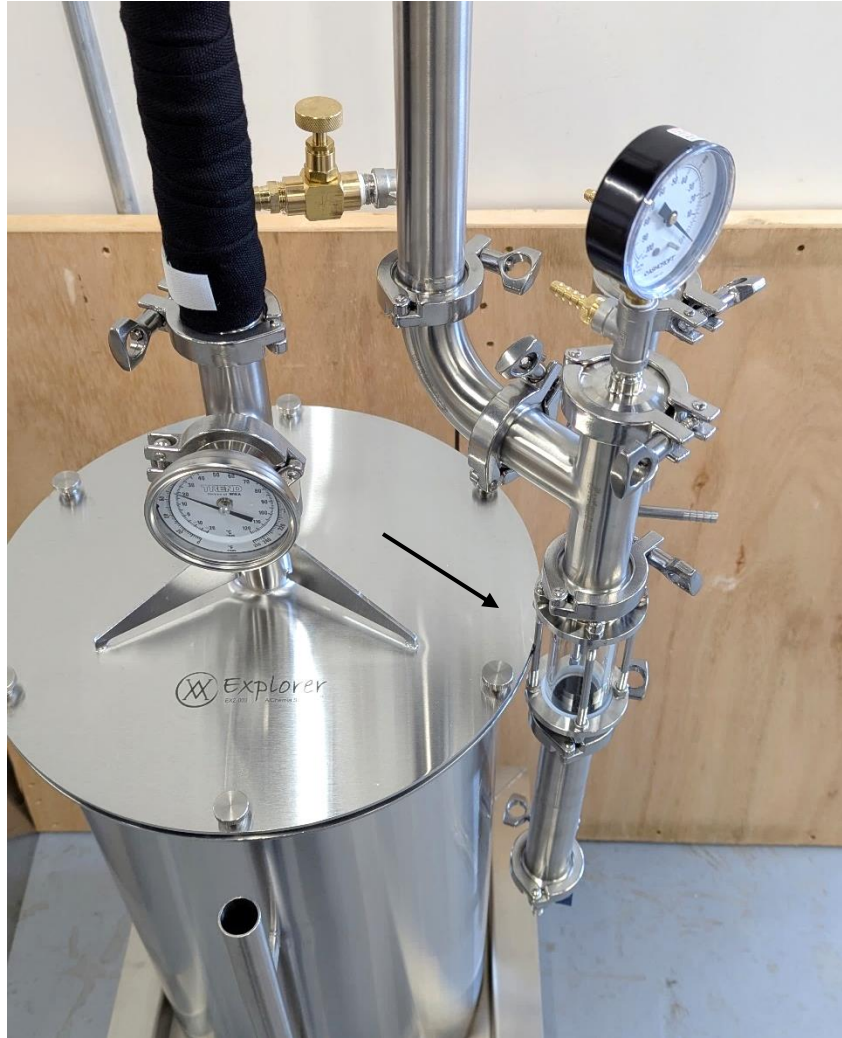
Photo 8 : Appui du vase florentin sous vide contre la bride et le couvercle de l'Explorer.
