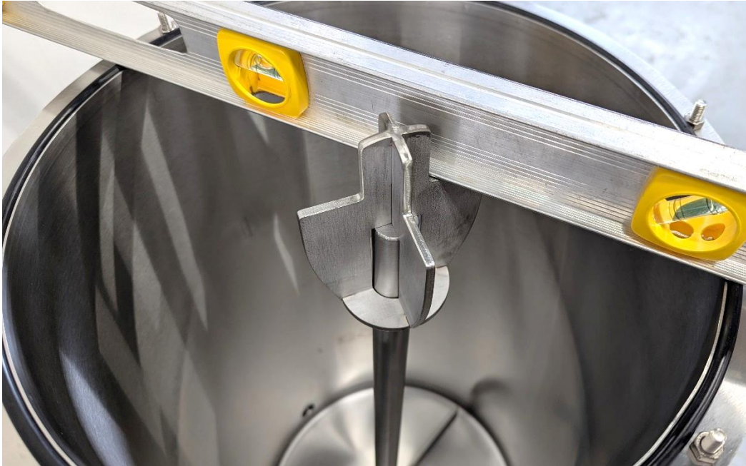
Photo 2 : Ensemble du pilier dans le réservoir. La hauteur du pilier doit être ajustée de sorte qu'un objet plan repose à la fois sur la tête du pilier et sur le joint torique, de chaque côté du réservoir.
